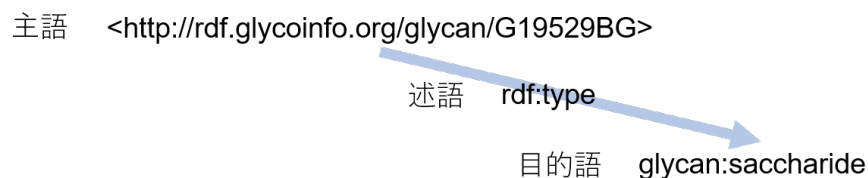
図 2.14 GlyTouCan で最も使われている RDF 表現のうちの一つ、主語の URI が糖質であることを示し、主語に数珠上につながるリソースにアクセスすることで、この糖質の情報を得ることができることをマシンに示唆している。
