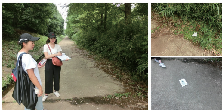
第2水辺公園の調整池周辺通路(▲4)での 地表面線量測定(上:土の上 下:アスファルト)
